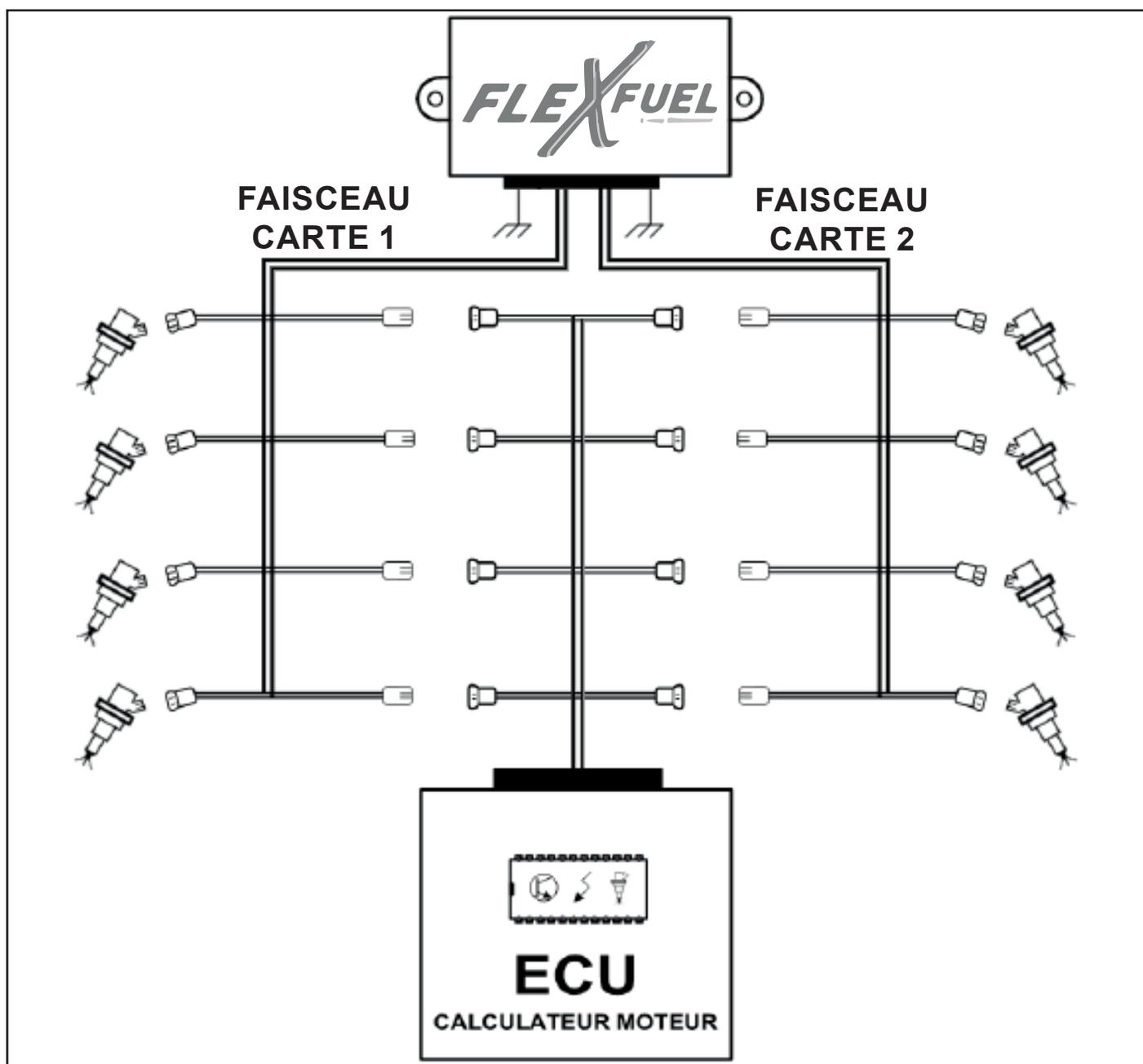
**NOTE :** Pour les moteurs de 6 à 8 cylindres, l'installation s'effectue avec 2 faisceaux montés en parallèle.
