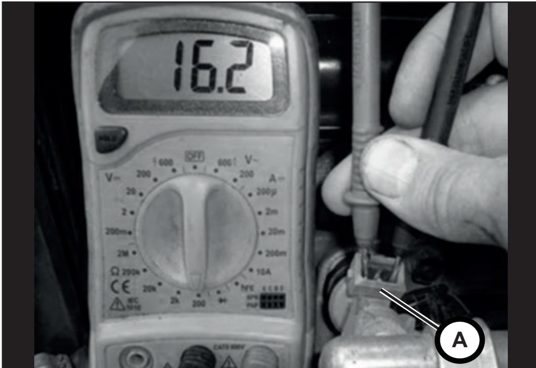
Mesurer l'impédance des injecteurs (A) à l'aide de votre outil. Elle doit être comprise entre 2 et 17 Ohms.
