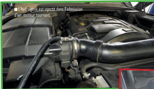
■ L'hydrogène est injecté dans l'admission d'air, moteur tournant.
