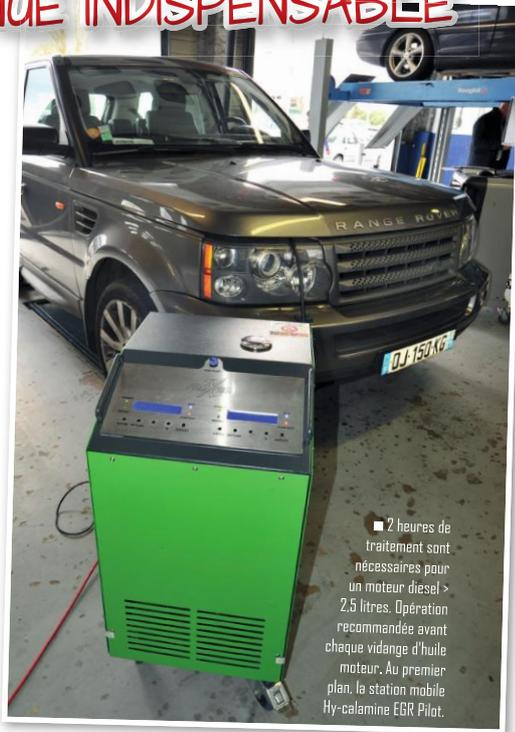
■ 2 heures de traitement sont nécessaires pour un moteur diesel > 2,5 litres. Opération recommandée avant chaque vidange d'huile moteur. Au premier plan, la station mobile Hy-calamine EGR Pilot.
