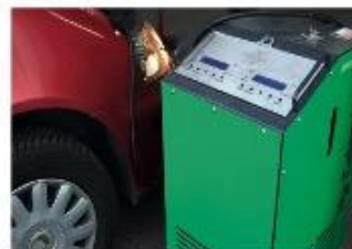
Développée par Flexfuel, cette machine nettoie les moteurs sans produits chimiques.
