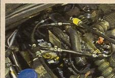
La machine Bardahl 360° est raccordée pour alimenter le moteur avec le produit décrassant.
