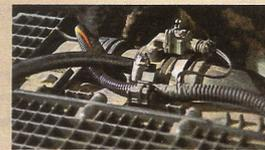
à la vanne EGR (à vérifier). Cette dernière est alors ouverte et fermée régulièrement pendant le cycle de 90 mn, moteur au ralenti. Les impuretés sont évacuées vers l'échappement. Un roulage sur voie rapide est nécessaire pour éviter de colmater le Fap. Coût : 150 €.
