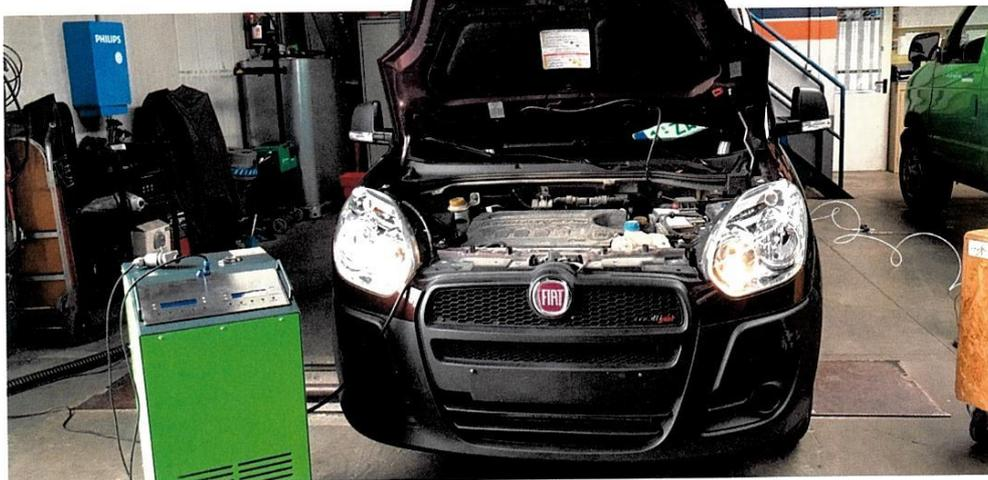
Le décalaminage par injection d'hydrogène réduit la consommation du véhicule et permet de récupérer les performances d'origine du moteur.
