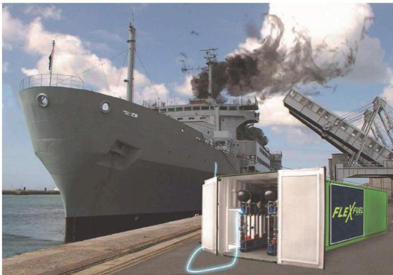
→ Sur ce photo-montage réalisé par Efinor et FlexFuel, le système permettant de fabriquer, puis introduire l'hydrogène dans le moteur d'un navire. La taille de la machine est fonction du moteur.
