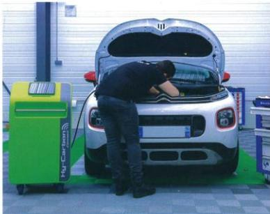
Le décalaminage par injection d'hydrogène nettoie les moteurs sans additif chimique, afin de les protéger de parasites (comme EGR, injecteur, turbo, FAP, etc.), tout en réduisant la pollution du véhicule et sa consommation de carburant.
