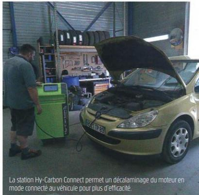
La station Hy-Carbon Connect permet un décalaminage du moteur en mode connecté au véhicule pour plus d'efficacité.
