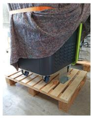
Une fois la station, sécurisée, mettre une protection épaisse, carton, papier à bulles, film plastique, couverture, etc, sur l'ensemble de la station, puis sangler.
