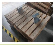
La palette de livraison de la station Connect dispose de cales métalliques destinées au bon maintien de la machine lors du transport.
