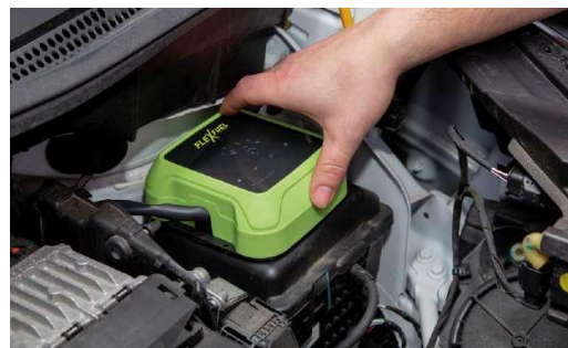
C'est ce type de boîtier qui permet de convertir un moteur à essence pour le faire fonctionner à l'E 85. Un investissement amorti en 13 000 km, en moyenne.
