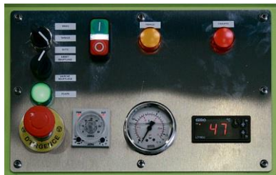
▲ L'ensemble des commandes et instruments de mesure de la station Carbon FAP est rassemblé sur un pupitre simple et fonctionnel, synonyme d'efficacité et de fiabilité pour le concepteur.
