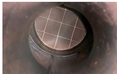
▲ Une fois traité par la Carbon FAP le filtre retrouve son aspect d'origine et l'intégrité de ses performances. Rappelons que le carbure de silicium qui compose le FAP est une matière, particulièrement résistante au choc thermique et mécanique, elle lui permet d'être reconditionnée - en théorie - autant de fois que la durée de vie du véhicule l'exige.
