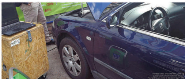
DN - Notre Passat voiture de test, branchée sur l'appareil qui pilotera les accélérations.
